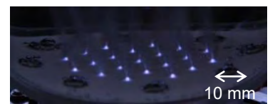
コンデンサをプラズマと電源の間に挿入して交流電圧を印加することで、水中気泡内プラズマの多並列駆動が可能です。
