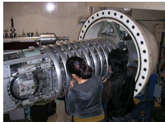
メンテナンス中の160万ボルト 静電イオン加速器
