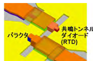
図4 周波数可変機能をもつ共鳴トンネルダイオードテラヘルツ光源。
