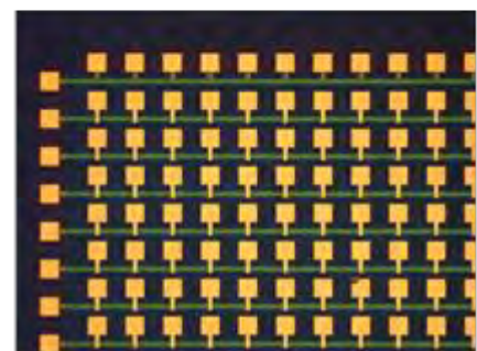
クロスポイント型集積構造 (概略図: 上, 実際に作製した構造の顕微鏡写真: 下)
